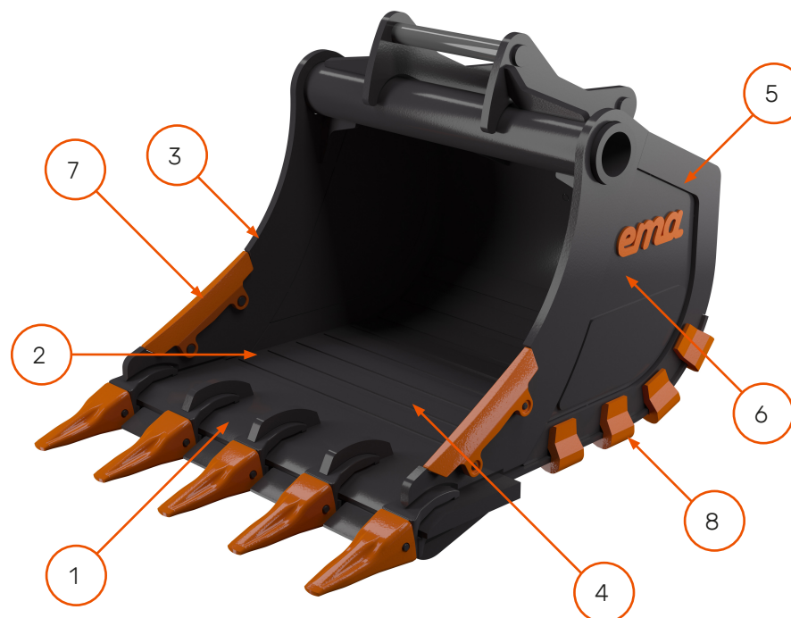
1. Skär Hardox® 500 2. Botten Hardox® 450 3. Kant Hardox® 450 4. Slitribbor Hardox® 500 5. Ram Hardox® 450 6. Sida Hardox® 450 7. Gavelskydd 8. Hälskydd VIKTIGT: Bilden visar ett exempel på hur det kan se ut på en viss modell, variationer på andra produktmodeller kan förekomma. Alla produkter är inte godkända enligt Hardox® in My Body. Fråga oss om ni vill veta mer.
