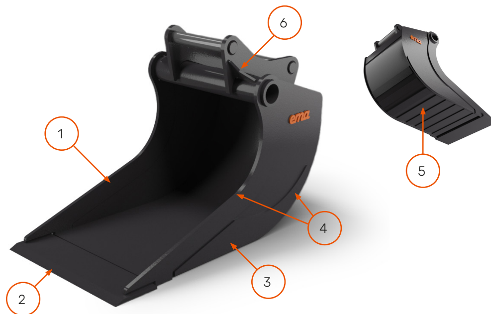
1. Lägre sidor 2. Skär Brinell Borox 500 3. Lång botten 4. Svep och slitskydd Hardox® 450 5. Ribbad botten Hardox® 450 6. Förstärkt vid fäste VIKTIGT : Bilden visar ett exempel på hur det kan se ut på en viss modell, variationer på andra produktmodeller kan förekomma. Alla produkter är inte godkända enligt Hardox® in My Body. Fråga oss om ni vill veta mer.
